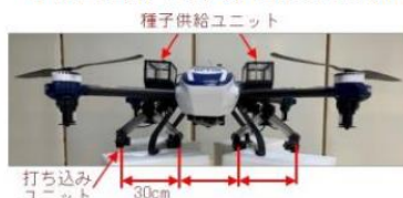
図1 開発した播種機を自動飛行ドローンに装着した状態
